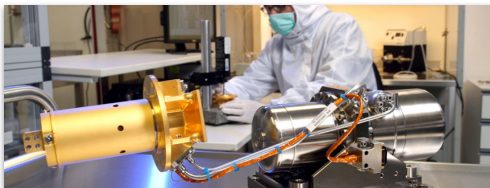
Tube à gaz pulsé fabriqué par Air Liquide sous licence CEA pour refroidir les détecteurs infrarouge de MTG.
