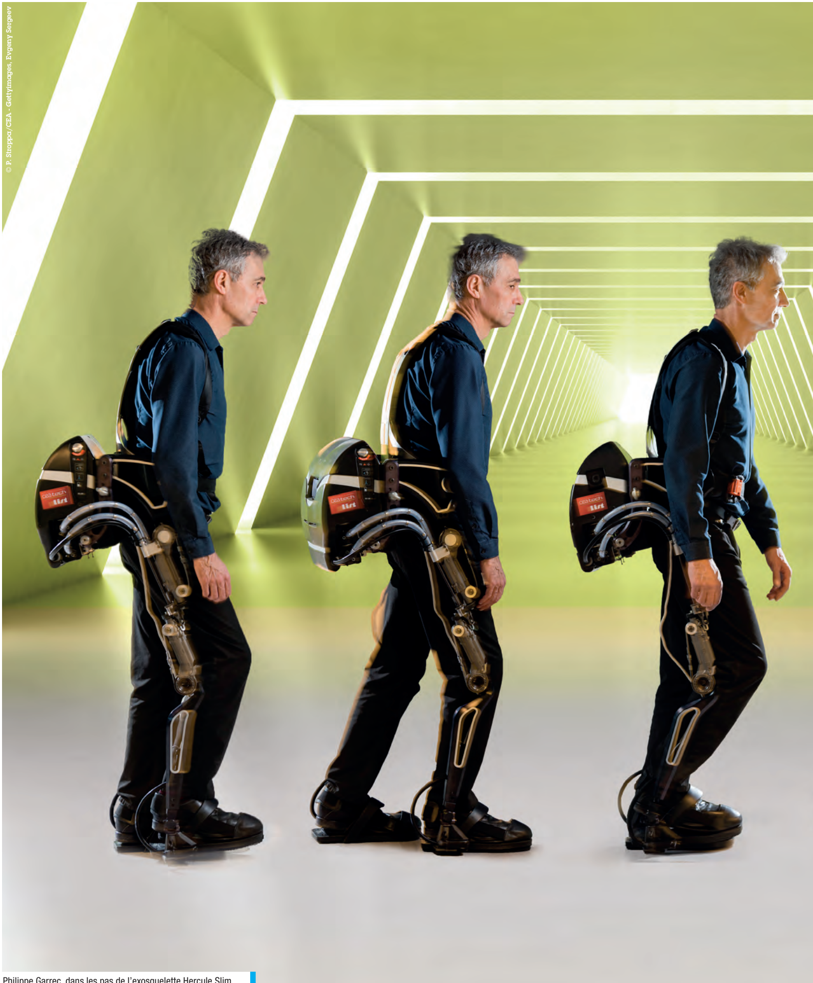
Philippe Garrec, dans les pas de l'exosquelette Hercule Slim, développé au CEA-List pour l'assistance au port de charges.
